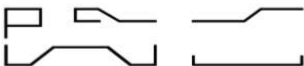
Рис. 5 Формы изгиба арматуры
