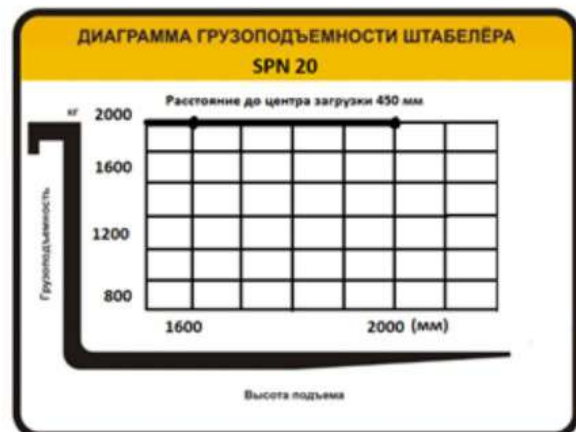
Рисунок. 4. Диаграмма грузоподъемности штабелера.
